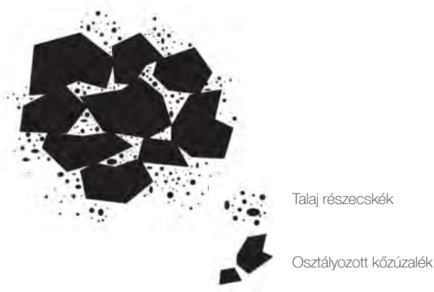
32. ábra: A mesterséges vázталaj (structural soil) sematikus ábrája
