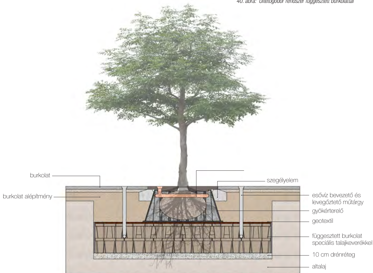
40. ábra: Ültetőgödör rendszer függesztett burkolattal
