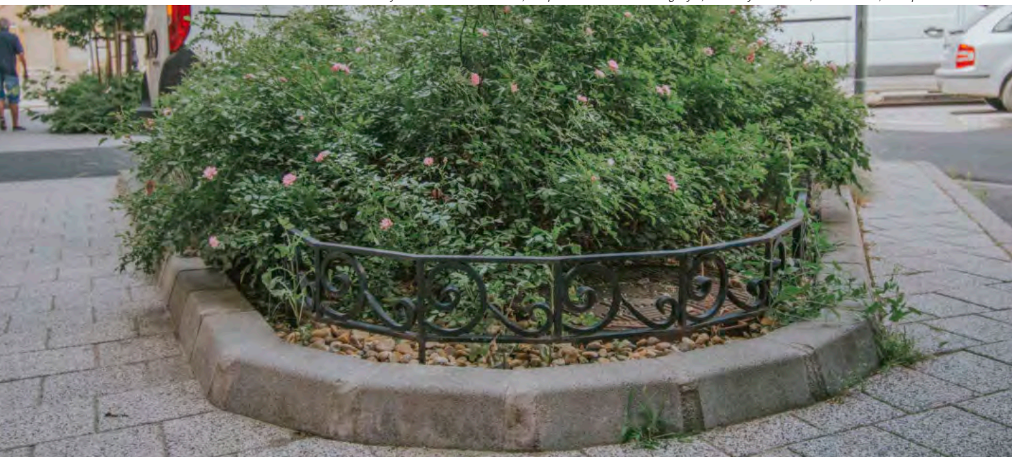
34. fotó: A fa közvetlen környezetének védelme sózás, áttaposás ellen kiemelt szegéllyel, alacsony kerítéssel, Roham utca, Budapest
