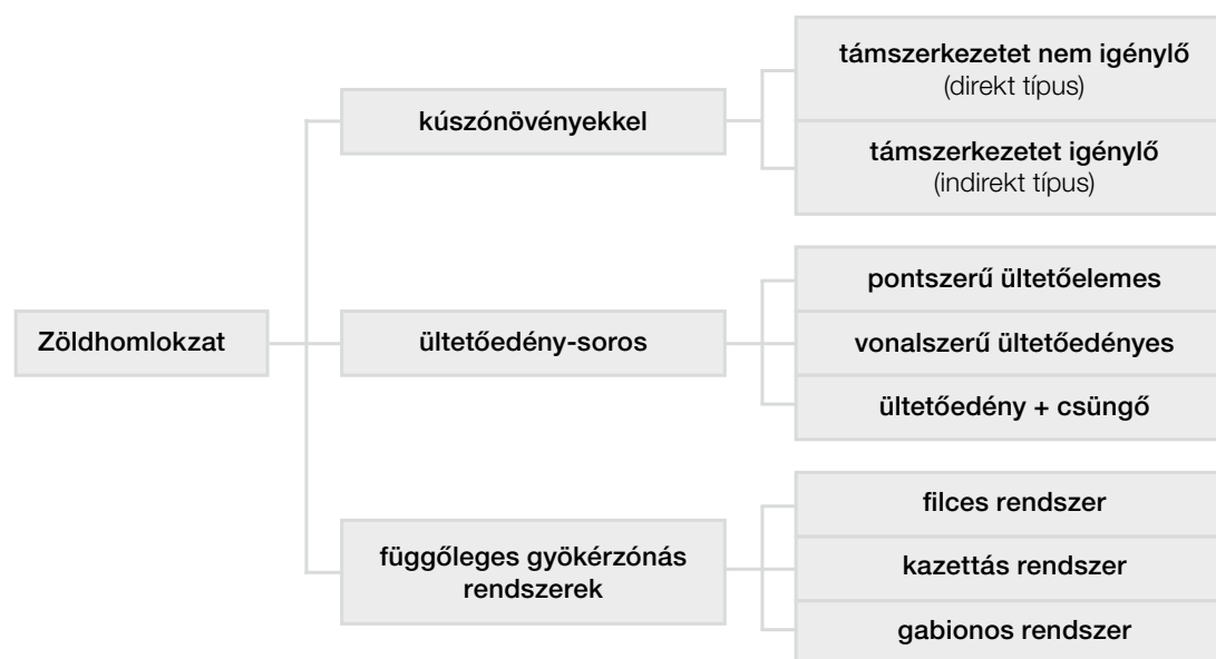
42. ábra Zöldhomlokzatok rendszerezése (Pataky)
