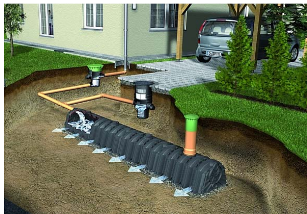
Szikkasztórendszer (kép: Kontakt-R Kft.)
